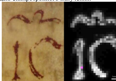
Рис. 1. Соответствие отсканированной области в видимом и рентгеновском диапазонах длин волн
